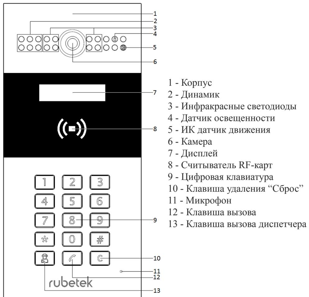
Рисунок 1 - Внешний вид панели (вид спереди)
