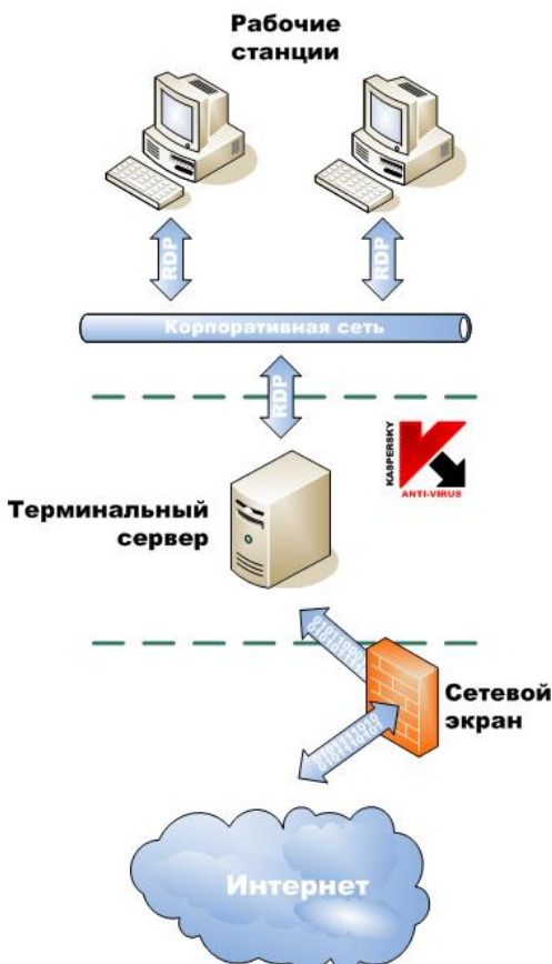
Рисунок 3. Схема защиты терминальных серверов
