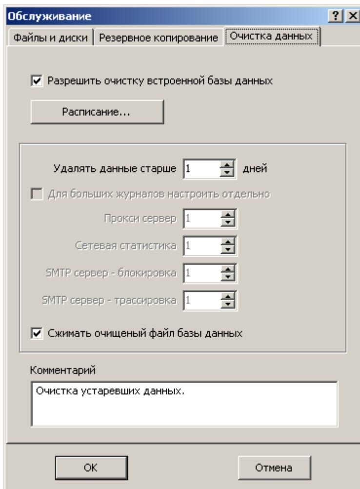
11. Синхронизацию и очистку данных можно запустить вручную в консоли Трафик Инспектор в разделе **Обслуживание**. Процесс синхронизации и очистки может занять продолжительное время, если встроенная база имеет большой размер.
