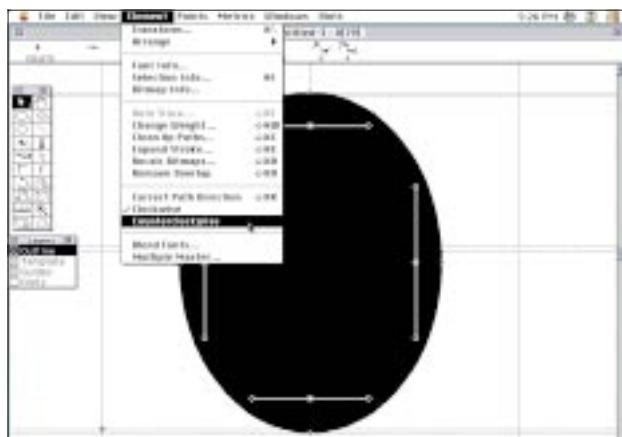
**12** Чтобы сделать внутренний элемент прозрачным, необходимо поменять направление контура на обратное. Не отменяя выделения, воспользуйтесь командой Element > Counterclockwise (элемент > против часовой). Диалоговое окно Transform позволяет перемещать, масштабировать, поворачивать и отражать точки и контуры.
